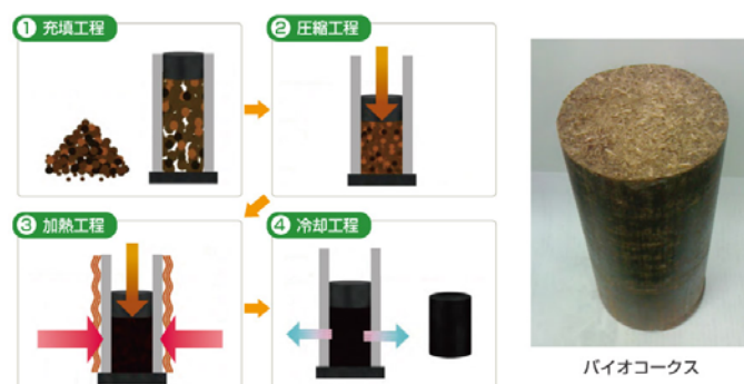
図. バイオコークスの製造工程
