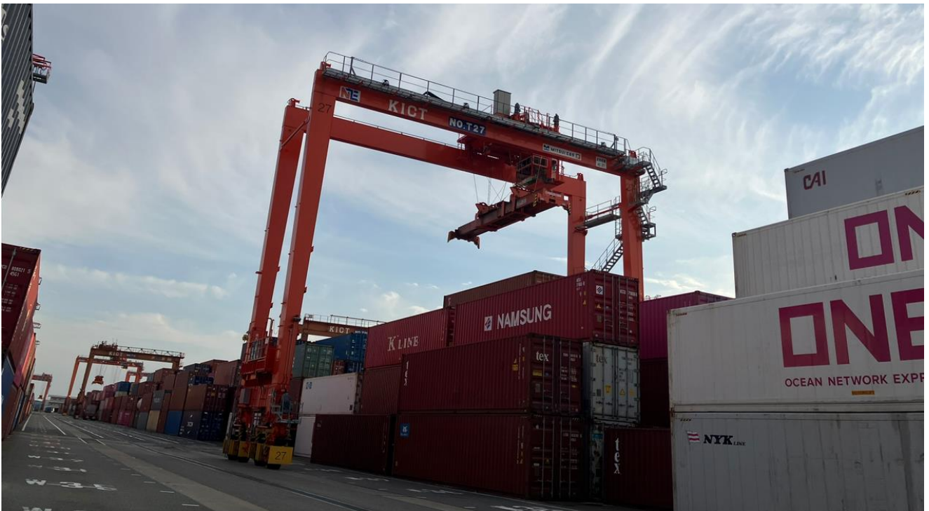
<神戸国際コンテナターミナルのタイヤ式門型クレーン>
